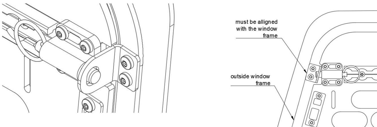
20. Copiez maintenant les trous du support de fermeture avec un crayon sur le profil de la fenêtre et marquez le centre.
