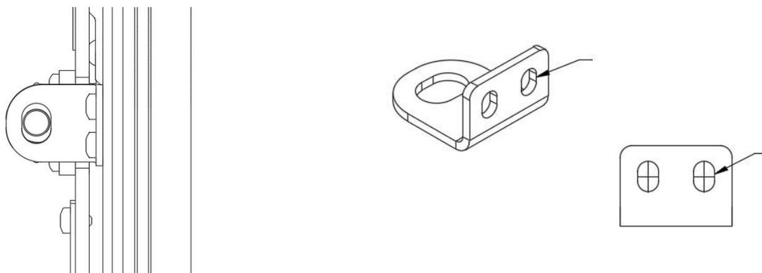
21. Percez complètement ces points centraux avec une foret de 4,2 mm et taraudez ces trous avec un taraud M5. Lubrifiez régulièrement la foret et le taraud avec de l'huile.
