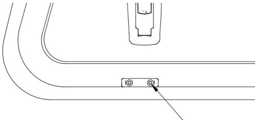
13. Percez complètement ces trous marqués de la plaque de base à travers le profil et la plaque de base avec une foret de 4,2 mm.
