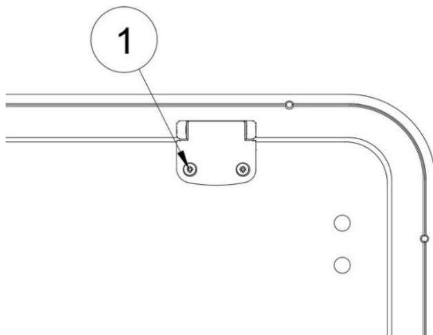
7. Lors de l'installation d'un Explore Overlander sur une fenêtre coulissante, remplacez la vis supérieure des loquets à ressort par la vis à tête cylindrique M5 x 20 fournie (1). Cette vis est recouverte d'un capuchon en plastique.
